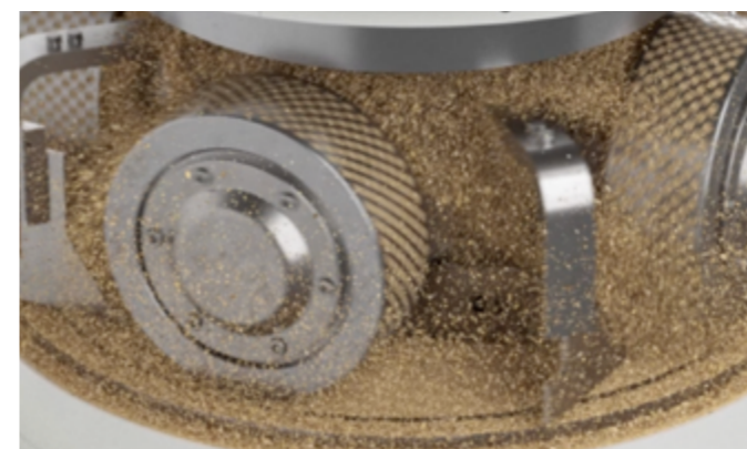
↑ Intérieur de la presse avec produit
